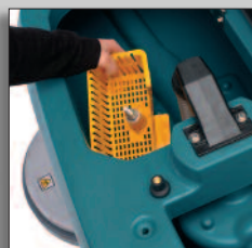
Bandeja de escombros
